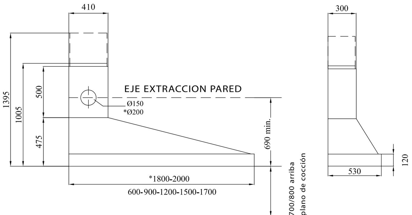
No conecte la campana a una salida menor de la prevista. Hay un riesgo de mal funcionamiento y de sobrecalentamiento del motor.
